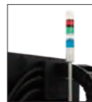
Indicatore luminoso di stato dei lavori
